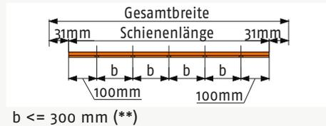
vertikale Anlaufschiene T **ST(G) 3**
